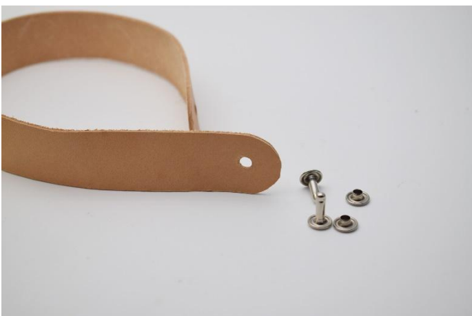
17. Klipp till din läderrem och runda eventuellt av hörnen. Gör hål till nitarna med en håltång
